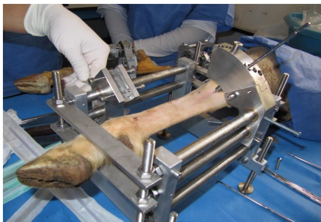
Fig. 19: Visión general del útil guía con una de las patas de prueba.
