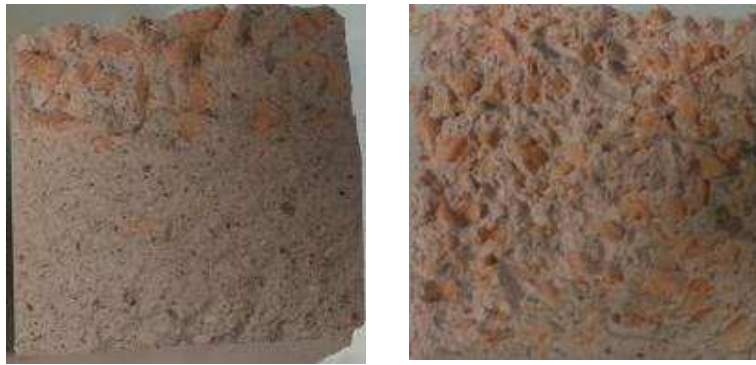
Fig. 2 “Sección de una muestra con 1% de residuo de XPS de 2-4 mm (izquierda) y una muestra con 4% de residuo de XPS de 2-4 mm (derecha)”
