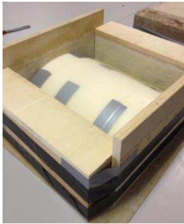
Fig. 6 “Colocación de las piezas de madera y el molde para reproducir un forjado real”. Fuente: los autores.
