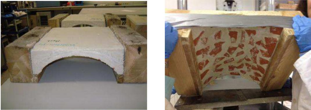
Fig. 9 “Pieza terminada tras el proceso de fraguado y dispuesta para ensayar”.
