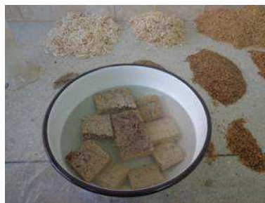
Fig. 6 “Ensayo del hinchamiento”
