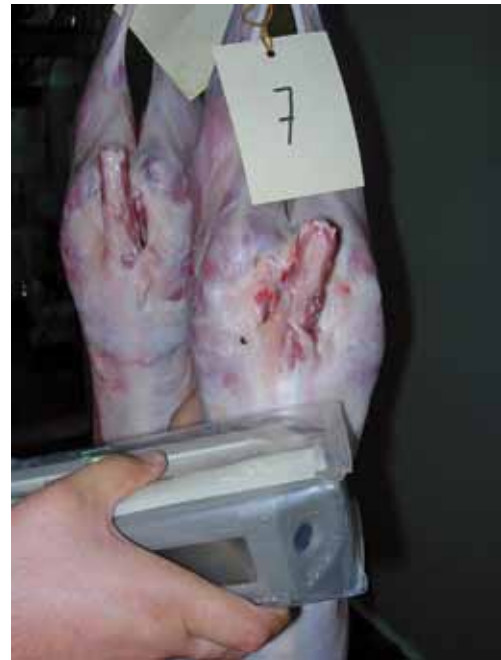
Figura 4. Determinación del color mediante un colorímetro Minolta
