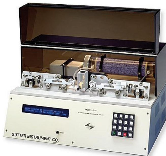
Figura 29. Estirador horizontal de vidrio (Puller, modelo P-97, Sutter Instrument Co. ) utilizado para la fabricación de micropipetas para registro intracelular.
