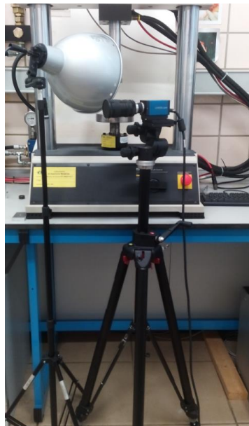
Figura A-3: Fuente de luz externa y cámara digital en su soporte
