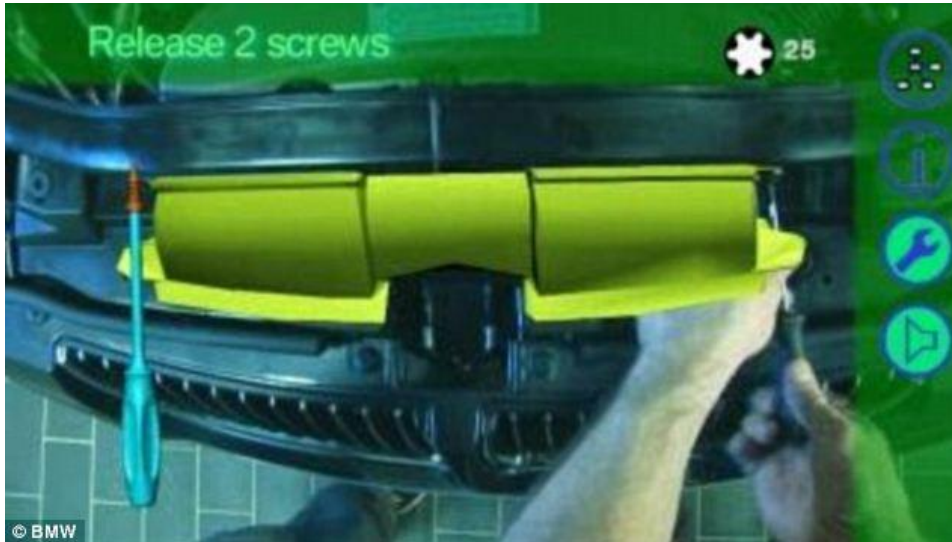
Figura 6-1 Captura del proceso de montaje en realidad aumentada desarrollado por la compañía BMW. [22]
