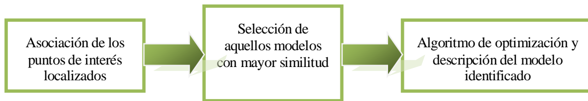
Figura 1-2: Pasos finales del proceso de extracción de características de una imagen.
