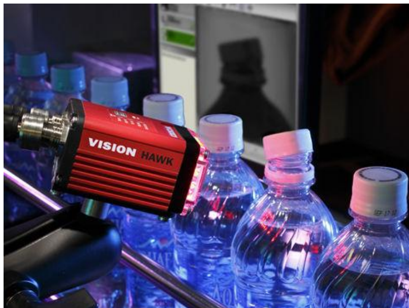
Figura 2-8 Cámara inteligente durante un proceso de embotellado. [20]
