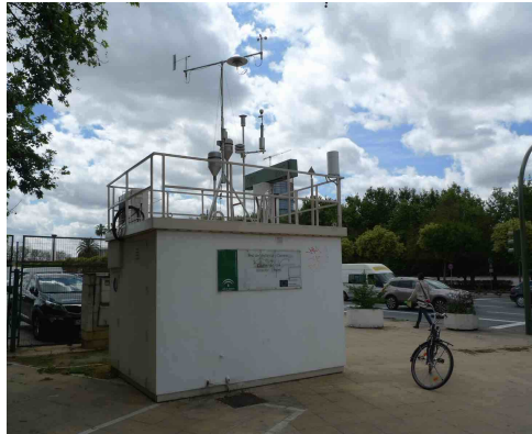
Figura 1.3 Estación fija de medida de la calidad del aire en la calle Torneo (Sevilla). En la parte superior de la estación se aprecian los diferentes equipos de medición. Véase detalle de su localización en la Figura 1.4B.
