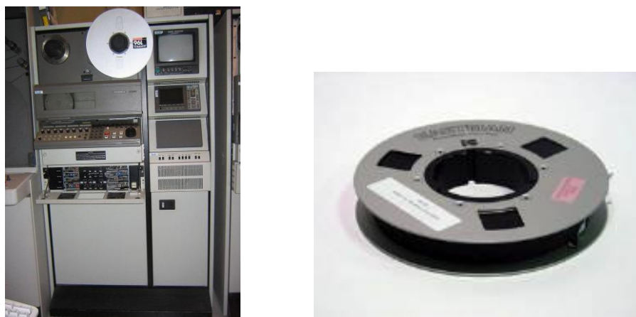
Figura 18: Magnetoscopio VPR 6 de Ampex (Formato 1" C) / Cinta de carrete abierto.
