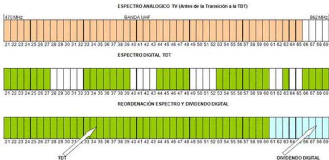
Figura 16: Evolución distribución del espectro en la implantación del dividendo digital.
