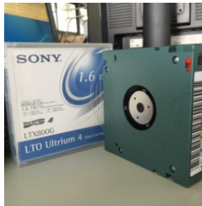
Figura 56: Cinta cintas LTO de archivo de 1,6 TB para almacenamiento a largo plazo.
