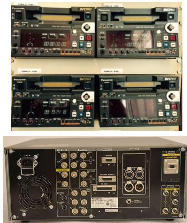
Figura 20: Magnetoscopios DVCPRO y parte trasera conexiones.
