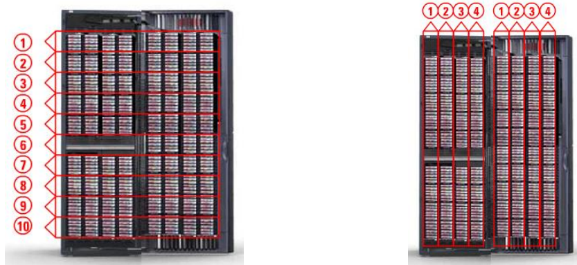
Figura 60: Interior Módulo Librería i2000. Estructura de Coordenadas
