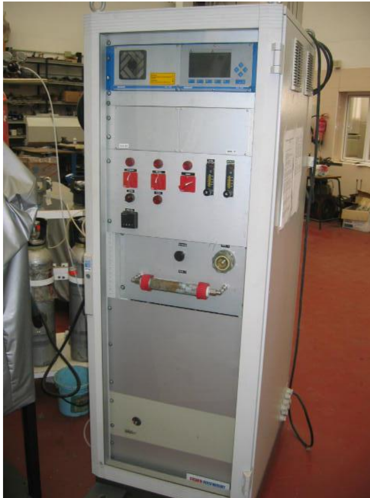
Figura A. 3: Analizador Fisher-Rosemount modelo NGA 2000.
