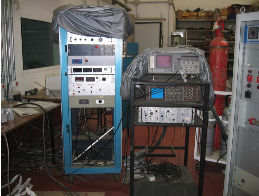
Figura A. 4: Equipo de control de freno y adquisición de datos.
