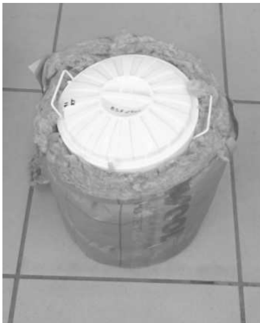
Figura 3.4: Reactor con aislamiento
