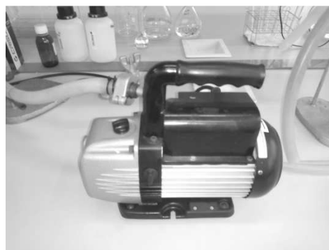
Figura 3.7: Bomba de vacío
