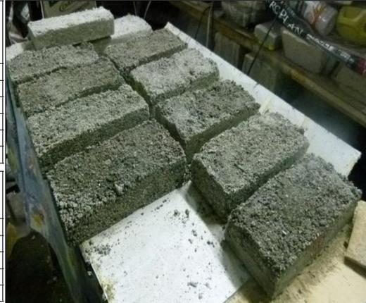
fig. 7 “Pruebas de búsquedas de mezclas densidad 1000k/m3 en formato ladrillos” aglomerantes y áridos unidad medida en kilos, EPS unidad medida en volúmenes
