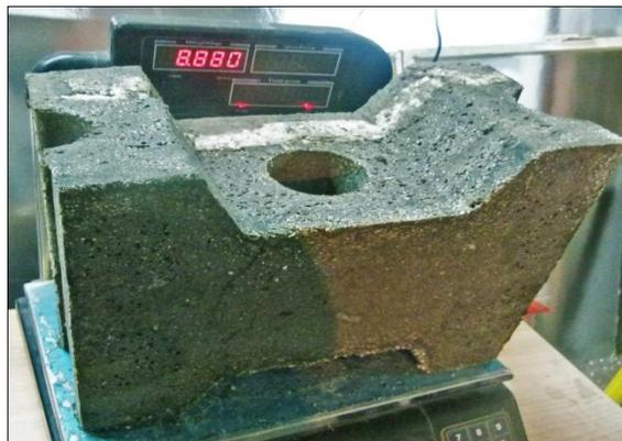
fig. 3 “Bloque Hache Plus con hormigón EPS 1000 k/m<sup>3</sup>”
