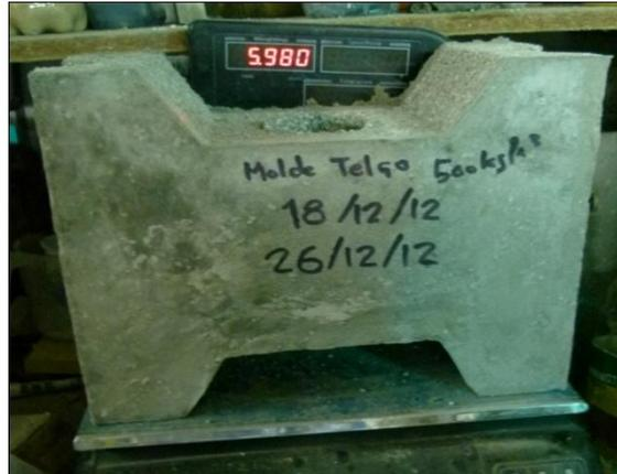
fig. 2 “Bloque Hache con hormigón EPS 500 k/m<sup>3</sup>”
