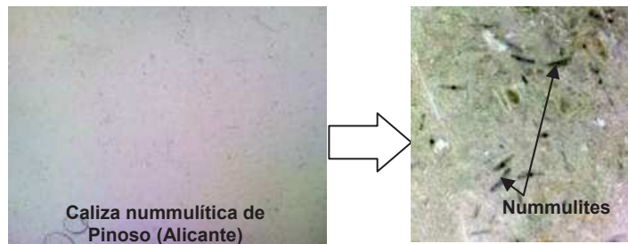
Figura 8. a) Aplacado de caliza “crema marfil” de Pinoso (Alicante) constituida por restos de nummulítidos y equinodermos; b) detalle con lupa de los microfósiles.
