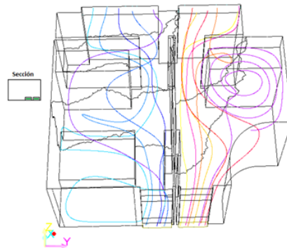
Figura 76. Líneas de flujo generadas para la configuración de huecos en el caso 4
