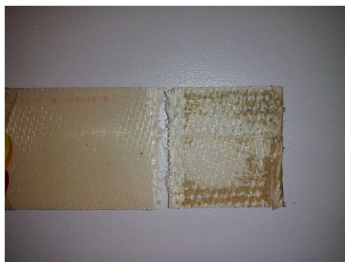
Figura 25 Detalle de la rotura de la probeta en la zona de la mordaza
