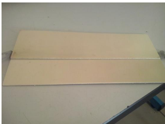
Figura 15 Panel de fibra de vidrio soldado
