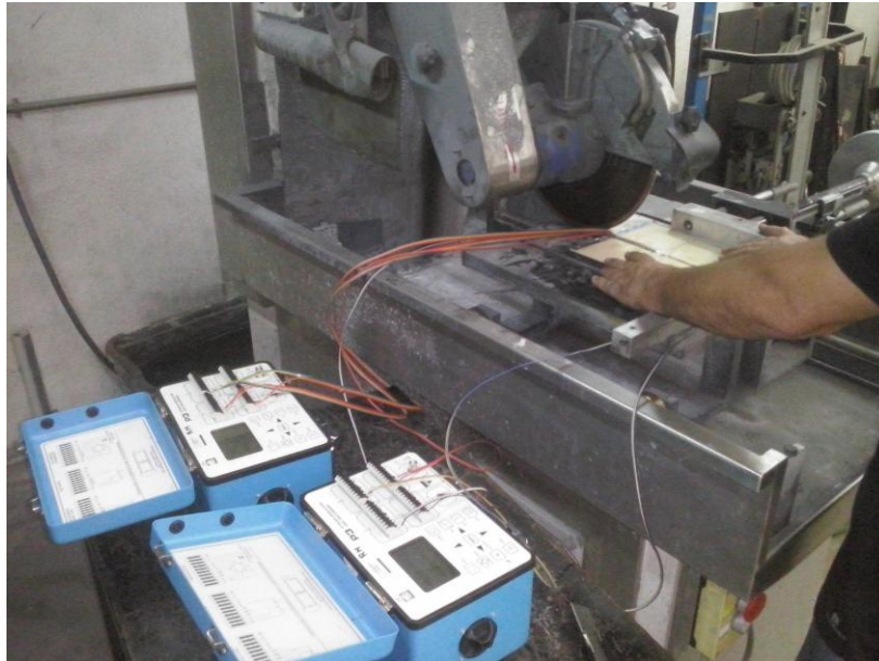
Figura 35 Mecanizado para la medida de tensiones residuales (2)
