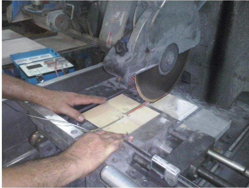
Figura 34 Mecanizado para la medida de tensiones residuales (1)
