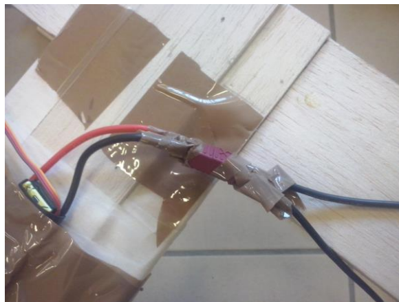
Figura 6.22. Conexión T-DEAN para la alimentación del variador alimentador por BEC.
