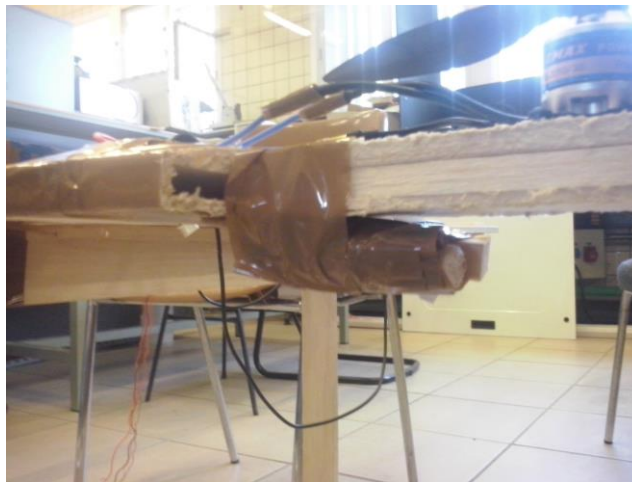
Figura 6.28. Peso colocado debajo del ala para la estabilización
