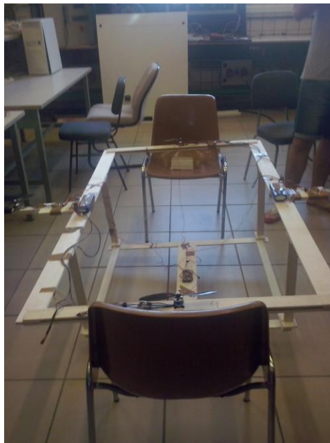
Figura 6.26. Experimento realizado para la estabilización estática sobre el eje X
