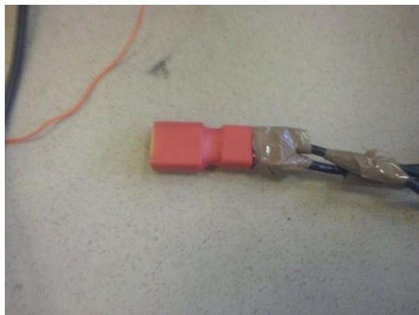
Figura 6.23. Adaptador XT60 – T-DEAN conectado al cableado de alimentación
