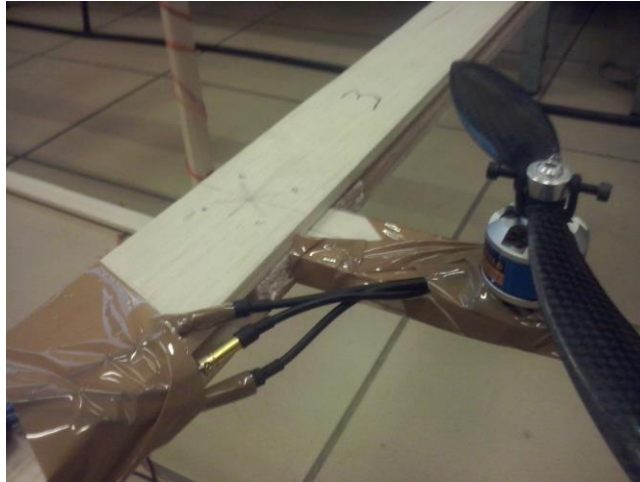
Figura 6.18. Plataforma de madera usada para albergar los motores verticales contribuyentes al par en Y. Nótese la marca de la posición anterior de dichos motores.
