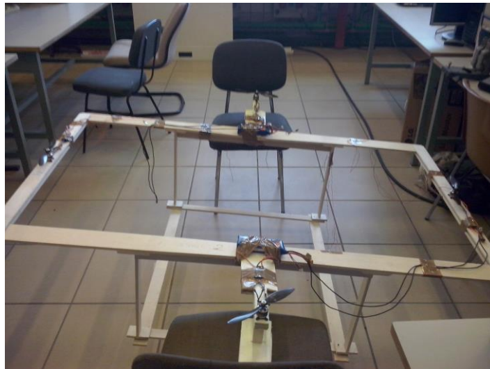
Figura 6.24. Experimentos realizados para la estabilización estática del vehículo sobre el eje Y
