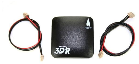
Figura 4.1. Módulo 3DR uBlox GPS con magnetómetro incorporado
