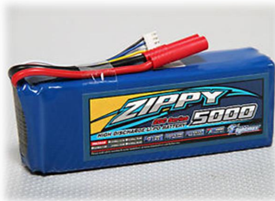
Figura 4.6. Batería Zippy 5000mAh 3S 20C-30C
