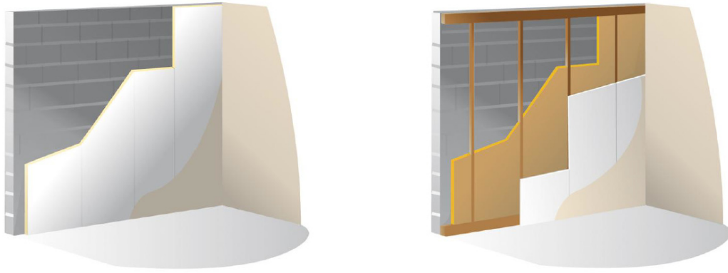
Fig. 5. “Técnicas de instalación utilizadas para poliuretano y poliestireno (izquierda) y lana de vidrio y lana de roca (derecha)”
