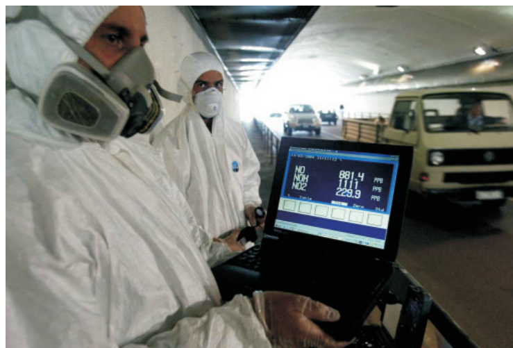
Fig. 6 “Medición de concentración de NOx en túnel”
