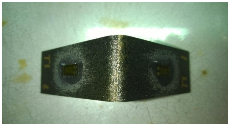
Figura 4.3-5. Resultado del pegado de bandas en las ILTS (1)
