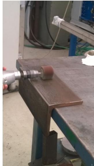
Figura 3-3. Lijado del molde
