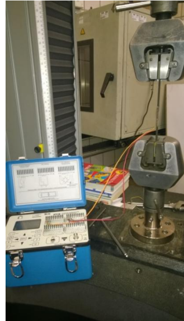
Figura 5.2-2. Puente de Wheatstone para medir las deformaciones
