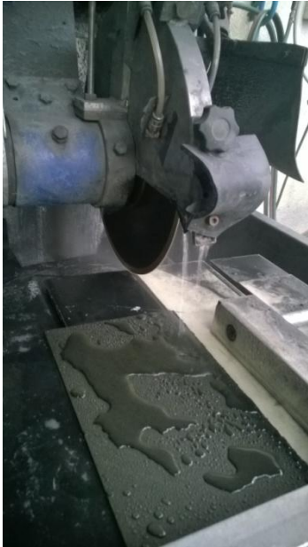
Figura 4.2-1. Corte de las probetas planas
