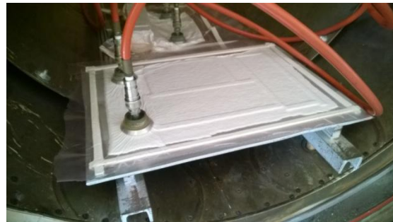
Figura 2.3-2. Configuración del molde en autoclave
