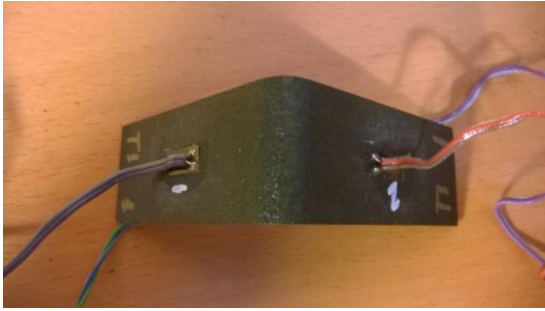
Figura 4.3-8. Resultado final de instrumentación sobre las ILTS (1)
