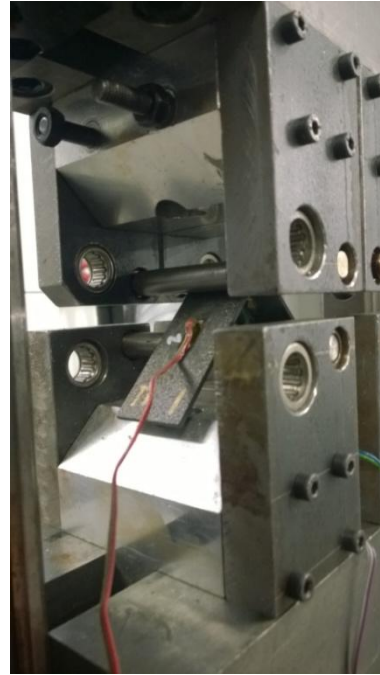
Figura 6-8. Vista lateral del ensayo ILTS (2)
