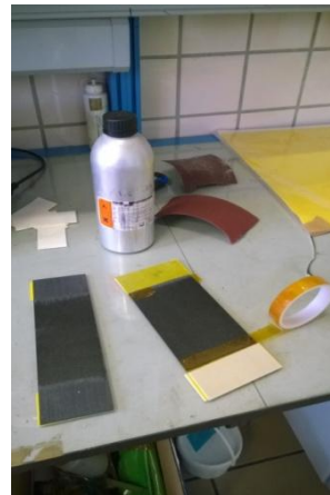
Figura 2.4-2. Proceso de pegado de los tacones
