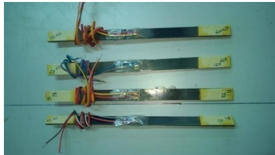
Figura 4.4-6. Probetas a tracción ya instrumentadas
