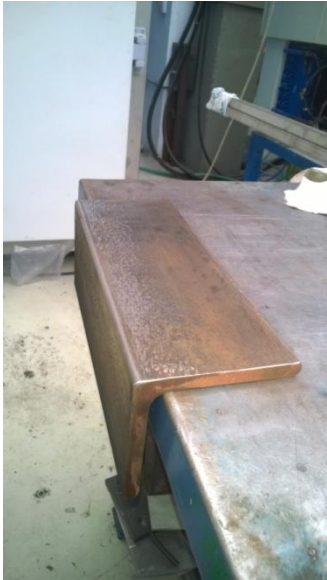
Figura 3-2. Molde usado para la laminación de las ILTS
