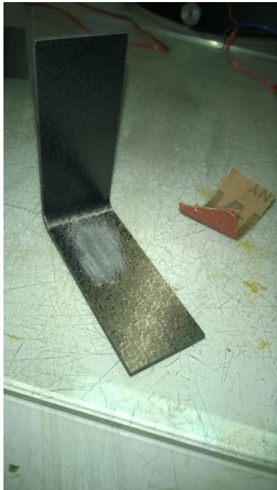
Figura 4.3-3. Lijado de la superficie a colocar la galga
