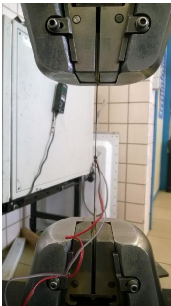
Figura 2.5.3-2. Ensayo de tracción en las probetas a \pm 45^\circ (1)
