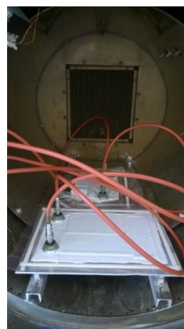
Figura 2.3-4. Autoclave ya listo para empezar el curado
