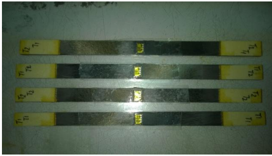
Figura 4.4-3. Pegado de las bandas en las probetas a tracción
