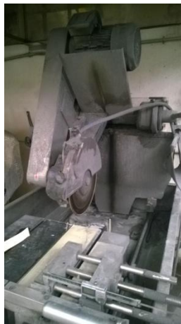
Figura 2.4-1. Sierra de abrasión del LERM
