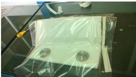
Figura 3-7. Colocación de la bolsa de vacío
