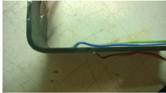
Figura 6-27. Detalle de la soldadura de los cables a las nuevas galgas
