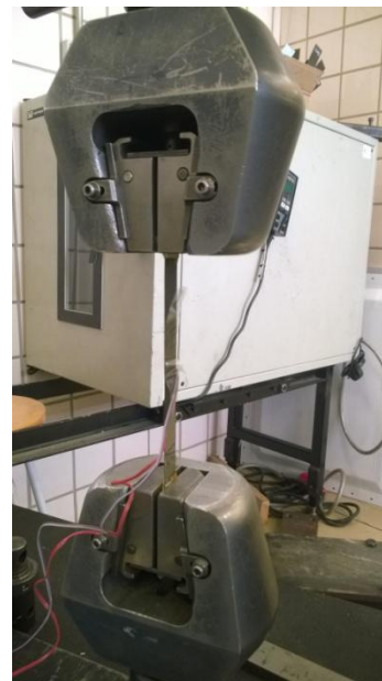
Figura 2.5.3-3. Ensayo de tracción en las probetas a \pm 45^\circ (2)
