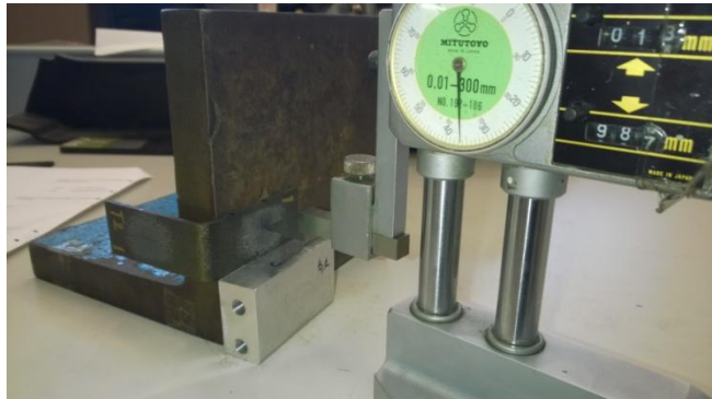
Figura 4.3-4. Marcado de la cruceta sobre la superficie lijada
