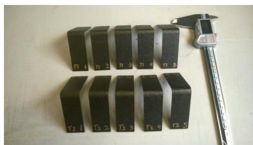
Figura 4.1-4. Medida de las probetas ILTS con calibre
