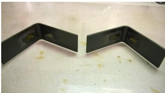
Figura 4.3-1. Posición de las bandas extensométricas (1) Figura 4.3-2. Posición de las bandas extensométricas (2)
