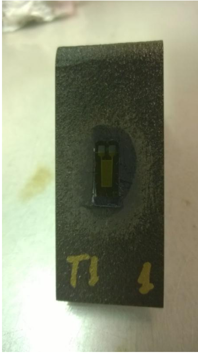
Figura 4.3-6. Resultado del pegado de bandas en las ILTS (2)
