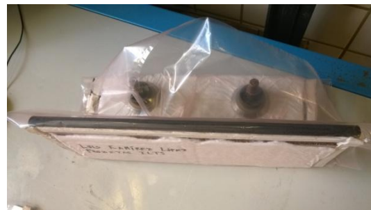
Figura 3-8. Molde ya preparado para el proceso de curado en autoclave
