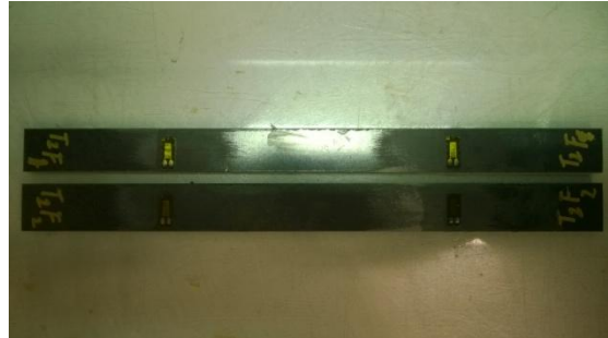
Figura 4.4-2. Pegado de las bandas extensométricas en las probetas a flexión
