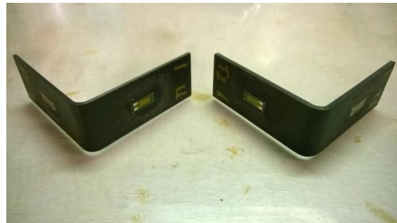
Figura 4.3-1. Posición de las bandas extensométricas (1) Figura 4.3-2. Posición de las bandas extensométricas (2)
