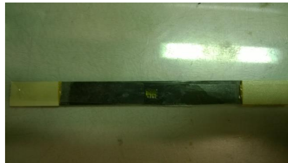
Figura 2.5.1-2. Colocación de banda extensométrica (2)
