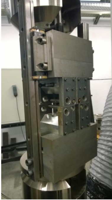
Figura 6-3. Utillaje para la realización del ensayo ILTS
