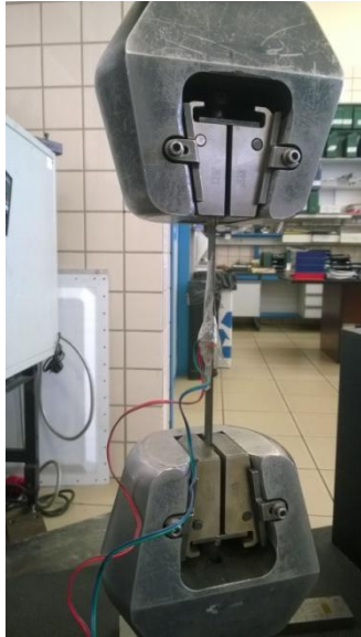
Figura 2.5.1-7. Ensayo de tracción de probetas a 0° Figura 2.5.1-8. Puente Wheatstone para medir deformaciones
