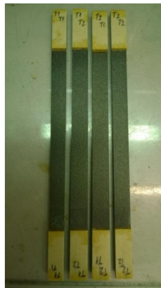
Figura 4.2-6. Probetas a tracción, ya cortadas, y con los tacones pegados
