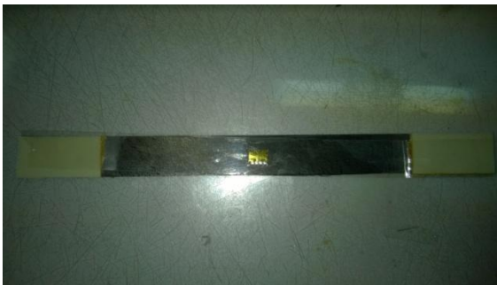
Figura 2.5.1-1. Colocación de banda extensométrica (1)
