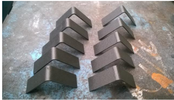
Figura 4.1-2. Probetas ILTS tras el proceso de corte
