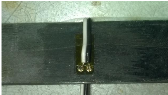
Figura 4.4-5. Detalle de la soldadura del cable a las conexiones de la galga
