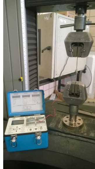
Figura 2.5.1-7. Ensayo de tracción de probetas a 0° Figura 2.5.1-8. Puente Wheatstone para medir deformaciones
