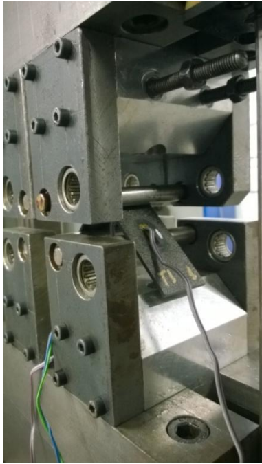
Figura 6-7. Vista lateral del ensayo ILTS (1)
