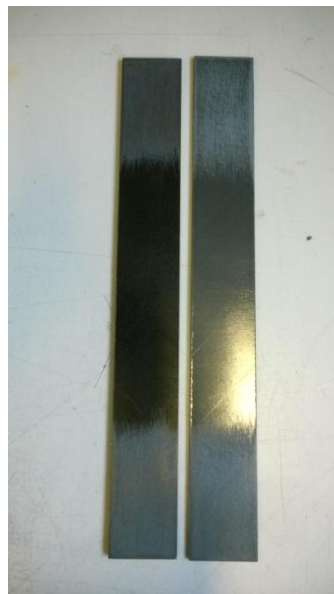
Figura 4.2-4. Paneles a tracción ya cortados
