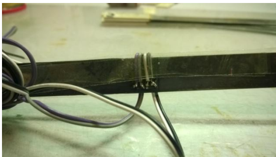
Figura 2.5.1-5. Detalle de la soldadura (1)
