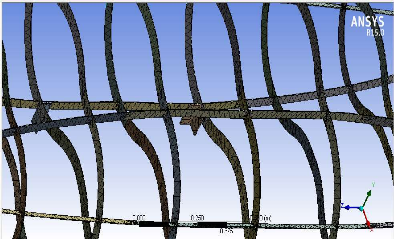
Figure 7- 42 Incremento de la densidad de Mallado de la estructura en las zonas de contacto, típico del Patch conforming.
