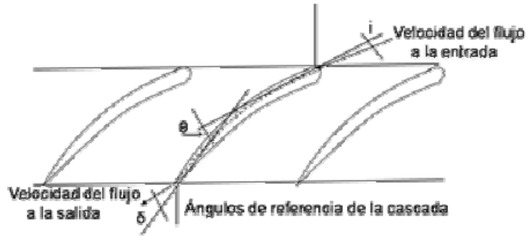
Figura 16. Esquema de parámetros de cascada de álabes.
