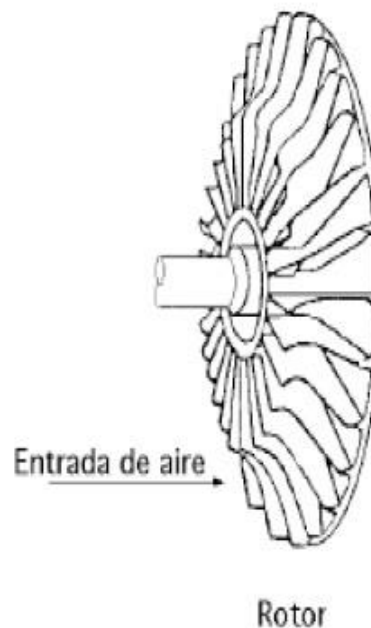
Figura 17. Compresor centrífugo de entrada axial y salida radial.
