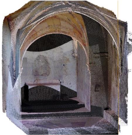
Figura 11. Vista sección transversal a través de la nube de puntos
