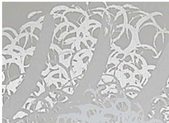
Fig. 43. Detalle de estampación directa con aplicación de bloqueador
