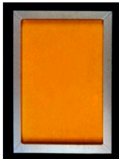
Fig. 74. Pantalla de aluminio soldado
