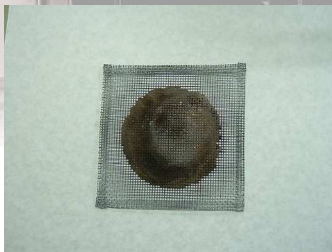
Imagen 57: Rejilla para prácticas en laboratorio con uso de fuego. Fuente: fotografía de la autora
