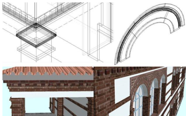
Fig.53. Proceso de elaboración de molduras y elementos decorativos de fachadas y pilares. (Elaboración propia; Allplan).
