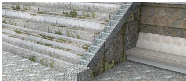
Fig.44. Animación de la escalera que da acceso a la galería de la fachada posterior, se observan los bloques de granito. (Elaboración propia; Allplan).
