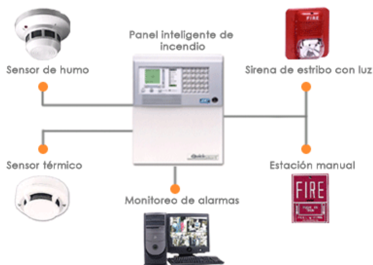
Esquema de un sistema típico de detección. Fuente: Informática comercial.com
