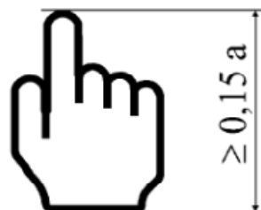
b) símbolo en la cara de accionamiento para activar el elemento de accionamiento en los pulsadores manuales de alarma de tipo B
