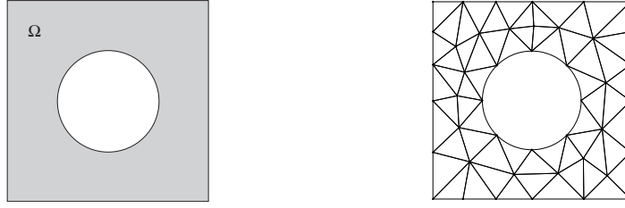
Figura 1: Dominio computacional con una parte del contorno definido mediante una curva NURBS (izquierda) y una triangulación válida para el uso del NEFEM (derecha)
