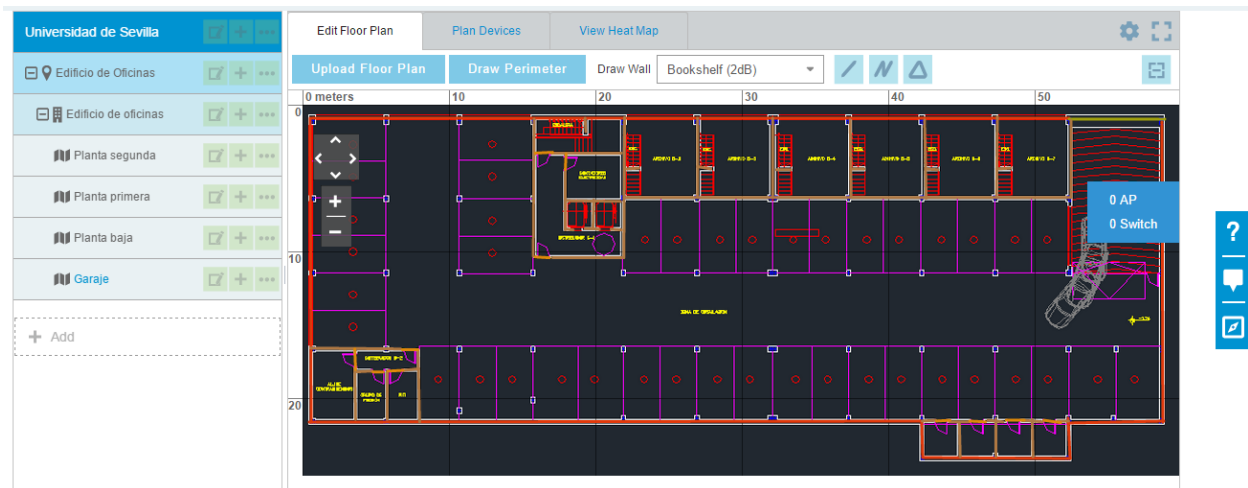
Figura 4-8. Ejemplo de plano de una planta con los diferentes elementos que causan pérdidas añadidos
