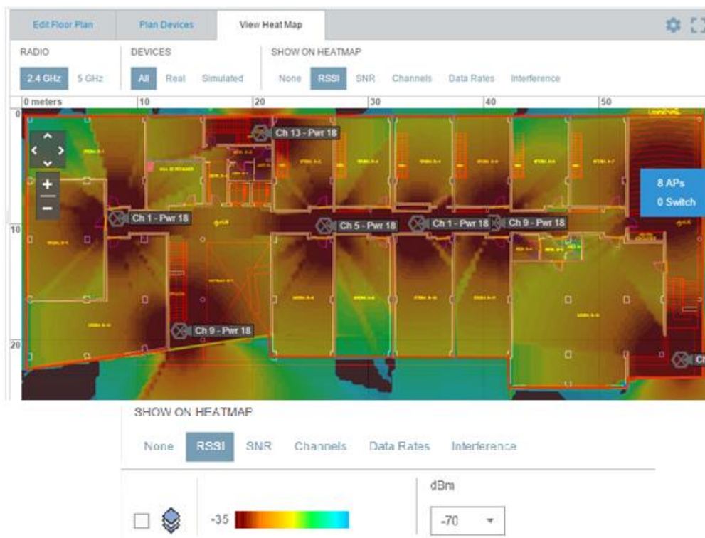
Figura 4-11. Nivel de señal a 2.4 GHz en la planta baja
