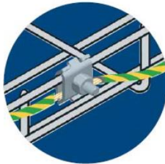
Figura 5-9. Instalación de puesta a tierra
