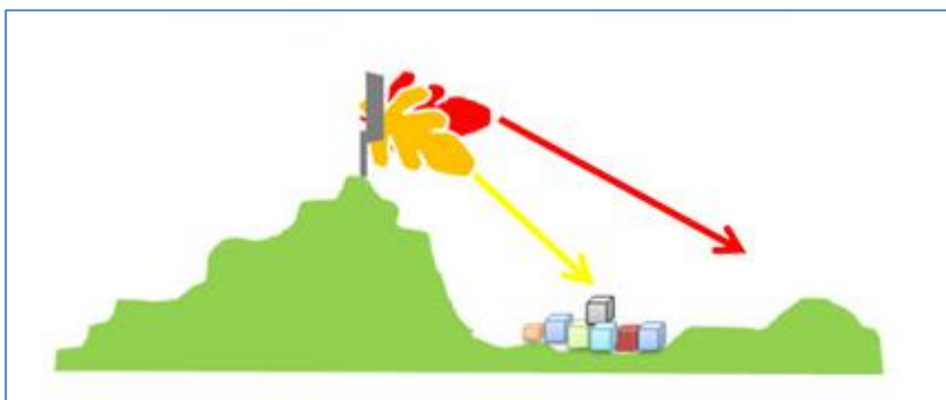
Figura 4-5 Tilt de las antenas
