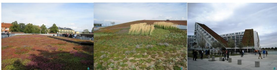
Figura 18: Ejemplo de cubiertas vegetales extensivas.
