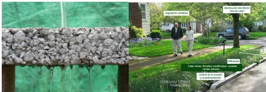
Figura 11: Imágenes de hormigón permeable y zanja de infiltración. Fuente: Ana Abellán
