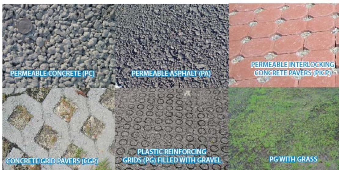
Figura 15. Diferentes tipos de pavimentos permeables. Fuente: William.
