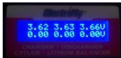
Figura 10 - Monitorización de la tensión de cada celda
