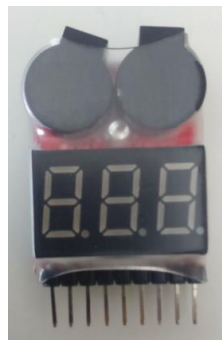
Figura 13 - Sistema de control de baja tensión
