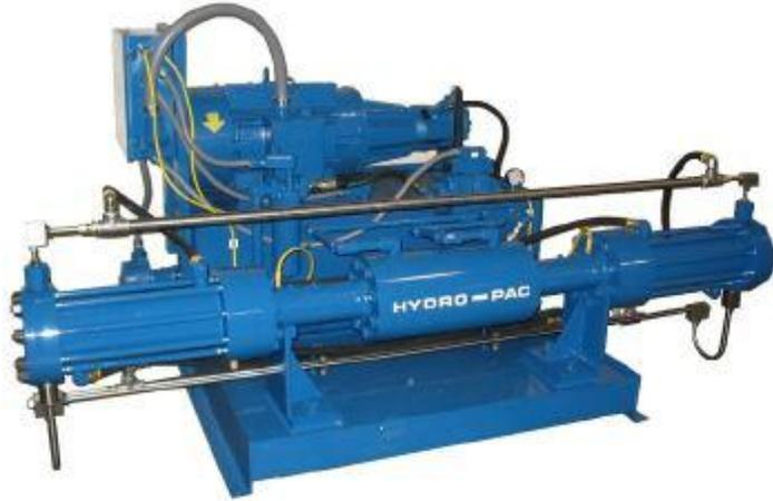
Figura 4-13 Compresor modelo C12-40-7000LX (Hydropac)
