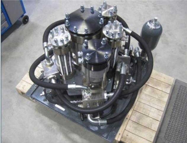
Figura 5-1 Fotografía de compresor de líquido iónico
