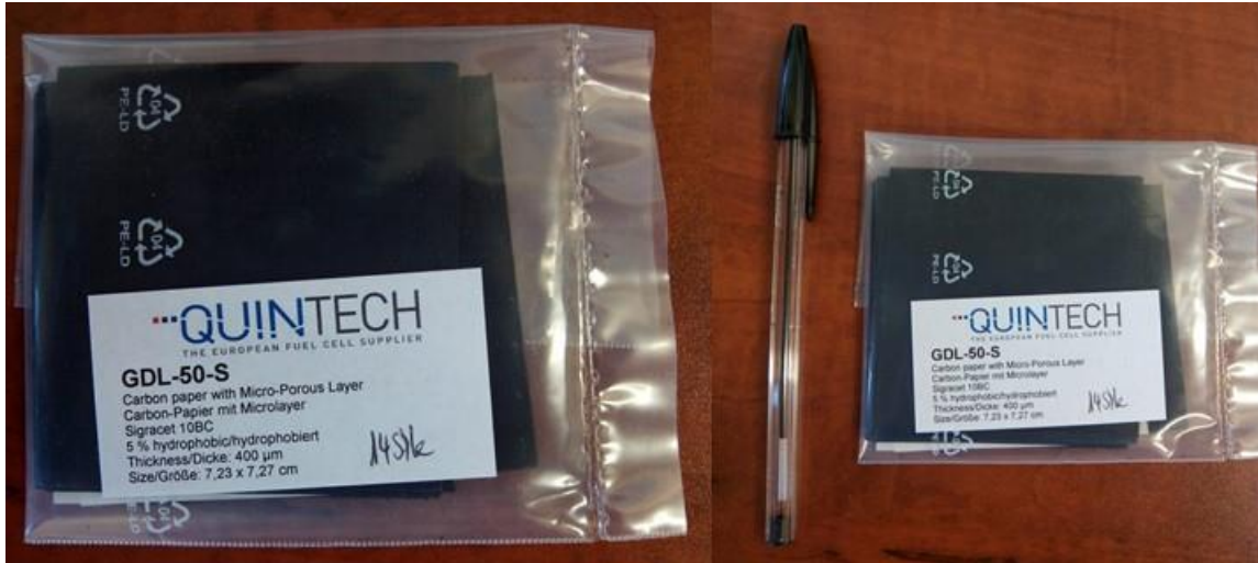
Figura 27. GDL utilizada en los ensayos experimentales en INTA (Sigracet 10BC)
