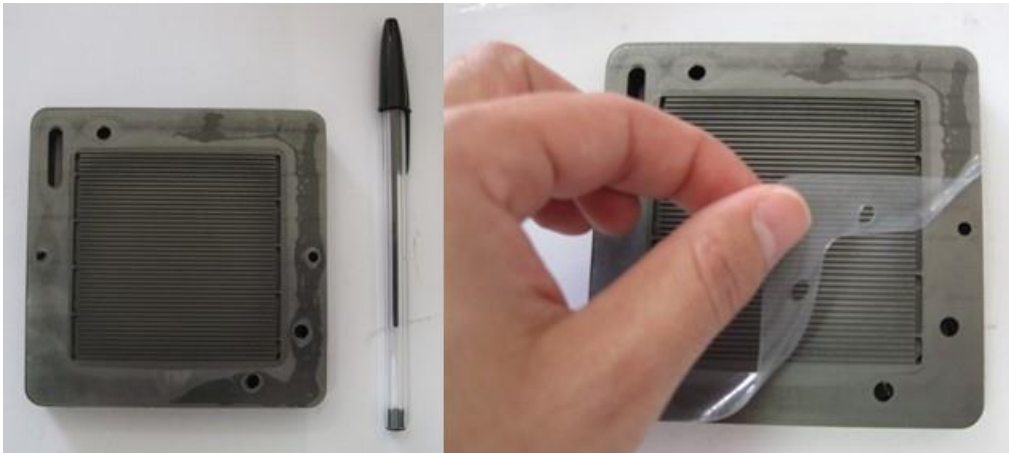
Figura 25. Placa bipolar de grafito utilizada en los ensayos experimentales en INTA
