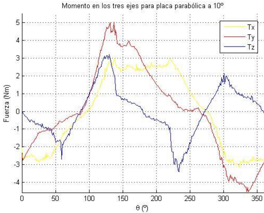
Figura C.3. Momento en los tres ejes para placa parabólica a 10^\circ
