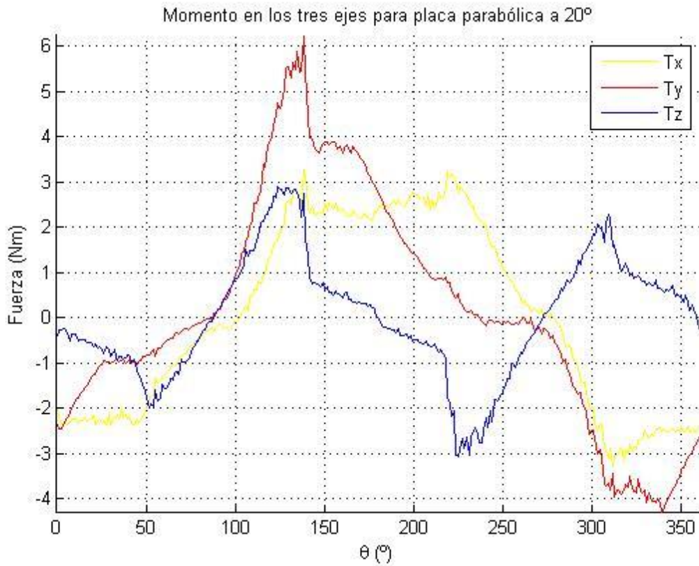
Figura C.5. Momento en los tres ejes para placa parabólica a 20°
