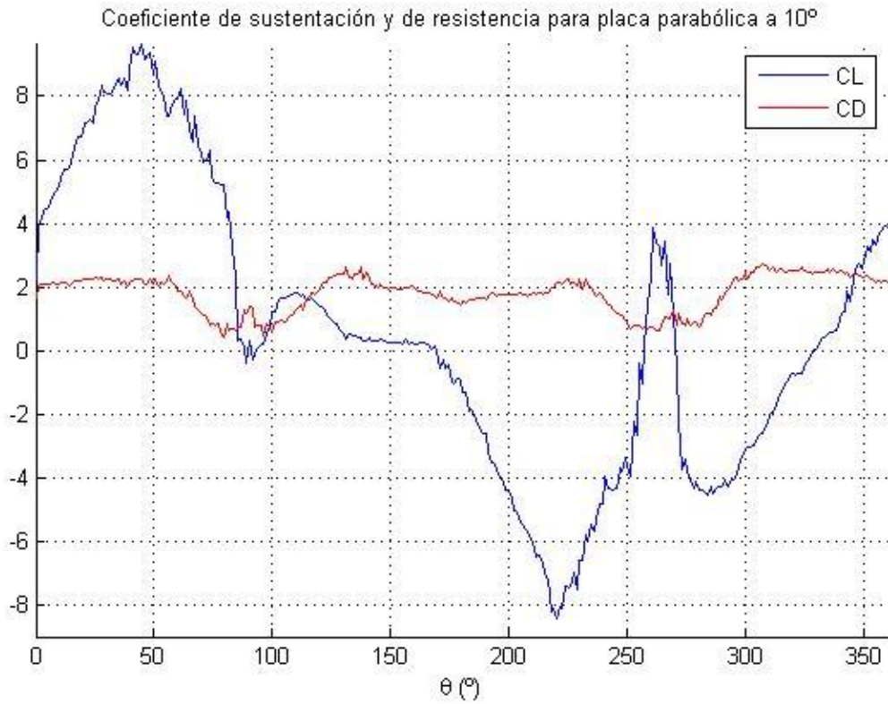
Figura B.3. Coeficiente de sustentación y de resistencia para placa parabólica a 10^\circ
