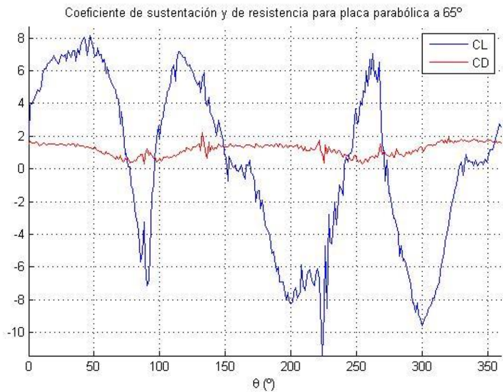
Figura B.14. Coeficiente de sustentación y de resistencia para placa parabólica a 65^\circ
