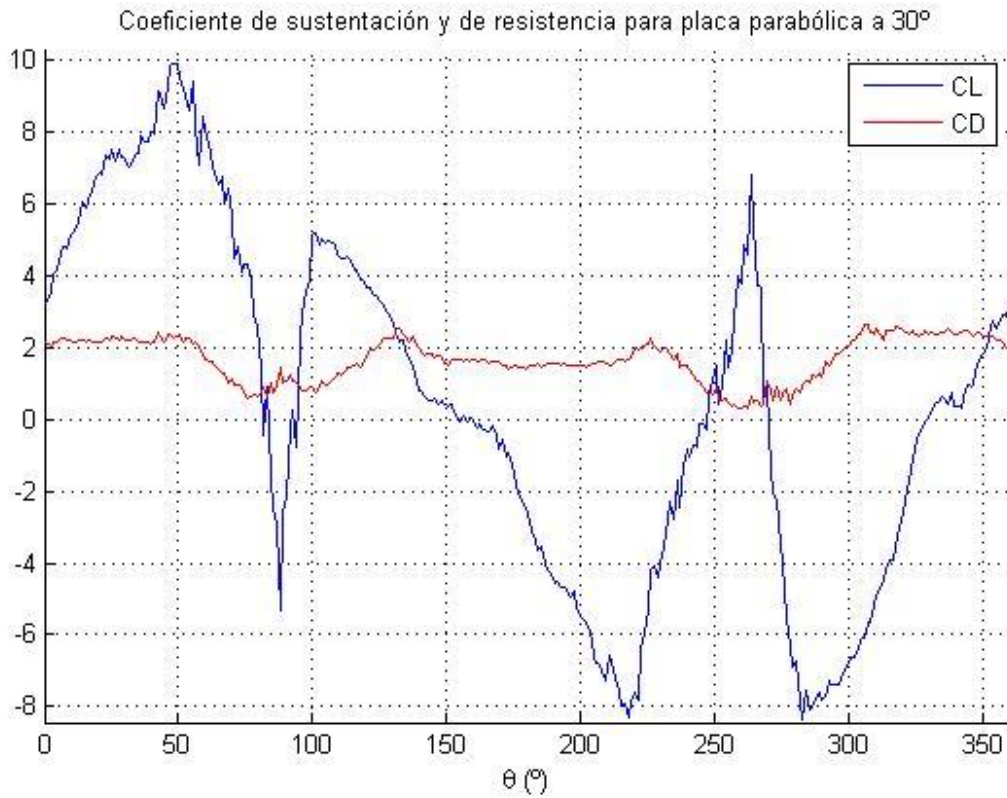
Figura B.7. Coeficiente de sustentación y de resistencia para placa parabólica a 30^\circ
