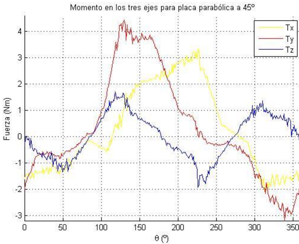
Figura C.10. Momento en los tres ejes para placa parabólica a 45°
