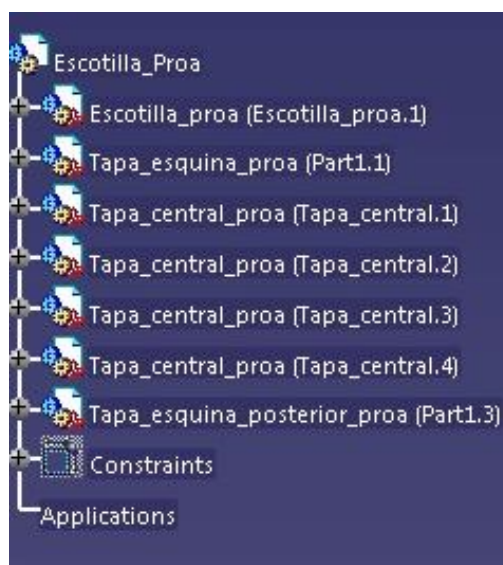
Figura 4.17: Árbol de componentes de la escotilla de proa.
