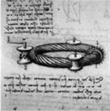
**Figura 1.11.** Tornillo y rueda dentada
