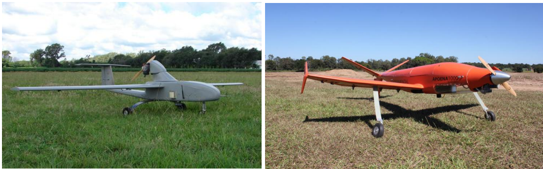
Figura 1. UAV's con motores de combustión interna
