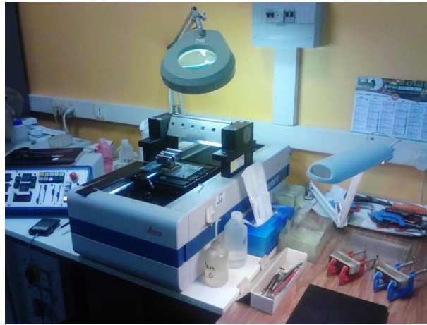
Figura 35: Microtomo especial para metacrilato Jung Polycute (Jung, Alemania).
