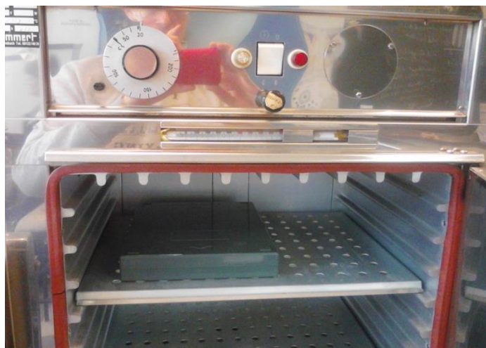
Figura 40: Kit de tinción y estufa de secado para tratamientos enzimáticos (TRAP y ALP).
