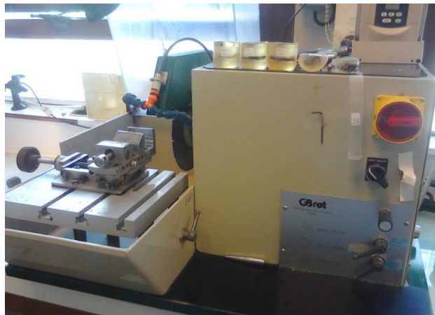
Figura 33: Corte y tallado de los bloques en sierra hidráulica.
