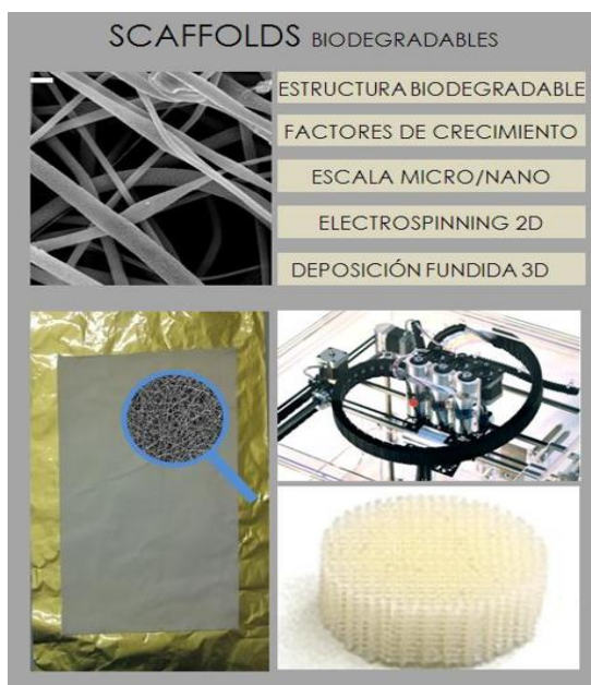
Figura 15: Imagen tridimensional de algunas matrices y técnicas de elaboración de andamios poliméricos para ingeniería de tejidos.
