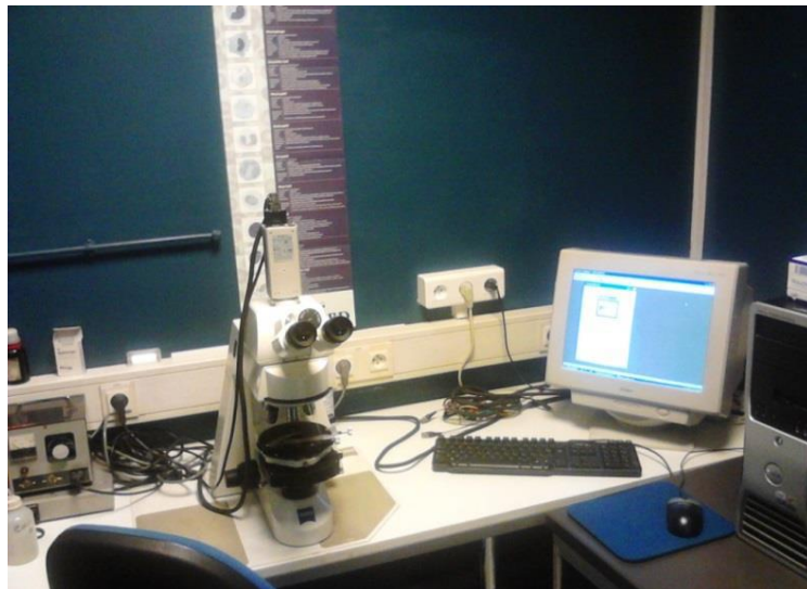
Figura 39: Microscopio de óptico de campo claro + ordenador personal de cuantificación y análisis de datos estadísticos.
