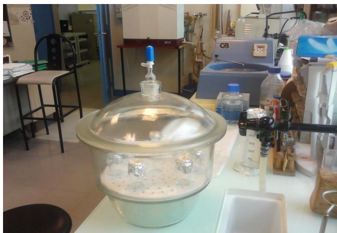
Figura 31: Impregnación y preinclusión a alta presión.
