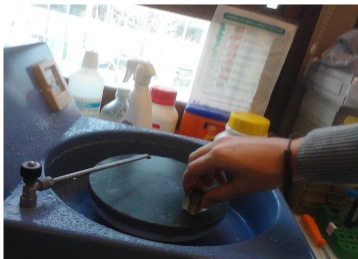
Figura 34: Pulido en lijadora de disco.
