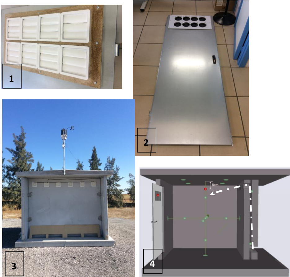
Figura 4-19. 1. Detalle de los ventiladores instalados en la puerta. 2. Nueva puerta instalada. 3. Deflectores instalados en la parte inferior de la fachada sur. 4. Detalle del movimiento de aire cuando se activa la ventilación nocturna.
