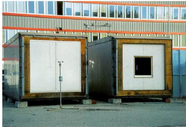
Figura 2-4. Imagen de las celdas Test de PASSYS [57], [65], [67]–[70] [59]
