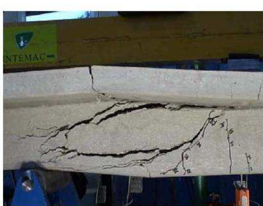
Imagen I.5.9.- Rotura por cortante en sección en T con axil de tracción (INTEMAC)
