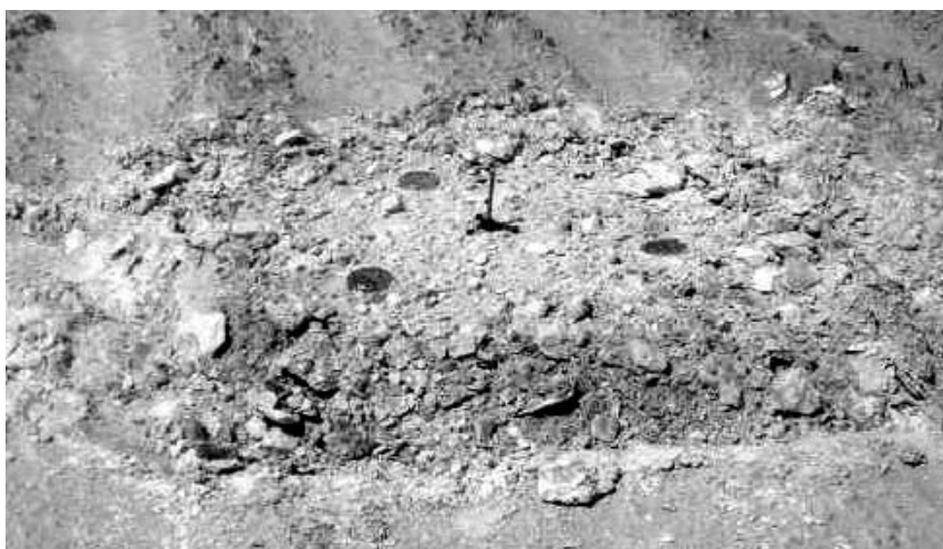
Figura 3.9. Trampas de Rn en zona con capa superficial removida.
