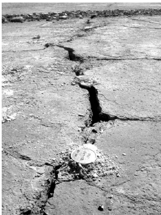
Figura 3.10. Trampas de Rn sobre una macro-grieta, en la zona 2.
