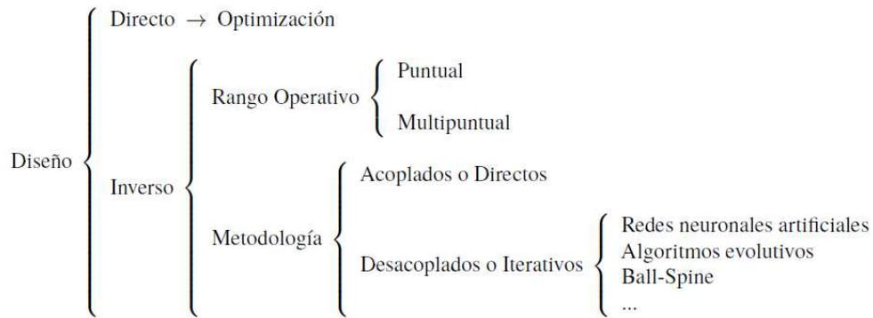
**Figura 1.22** Clasificación de los procesos de diseño.
