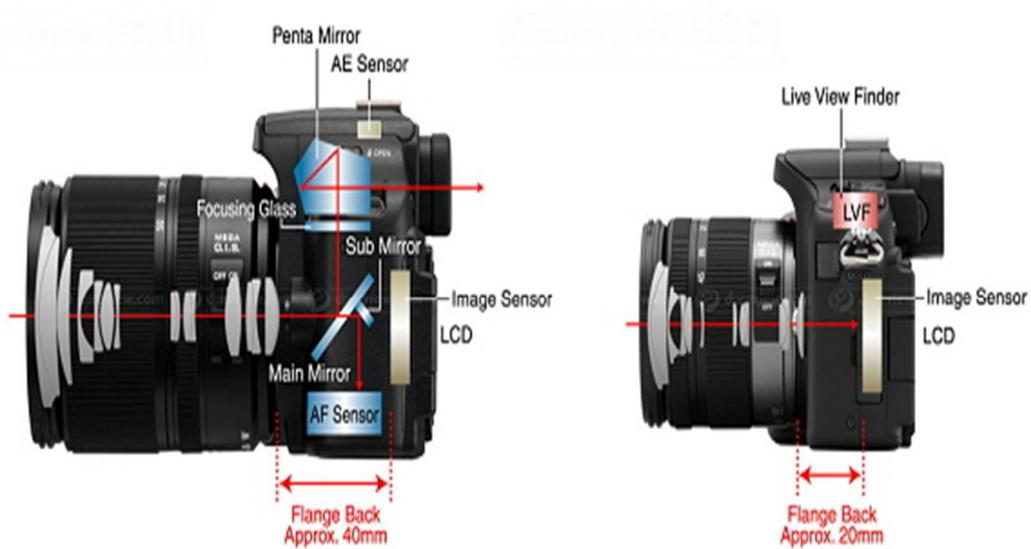
Estructura de una DSLR comparada con una Mirrorless. Fuente [www.camerasworld.net](http://www.camerasworld.net)
