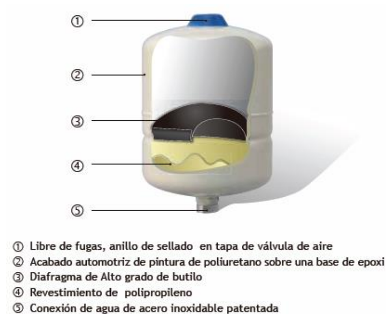
Figura 1.45 Esquema de la serie TWB de vasos de expansión
