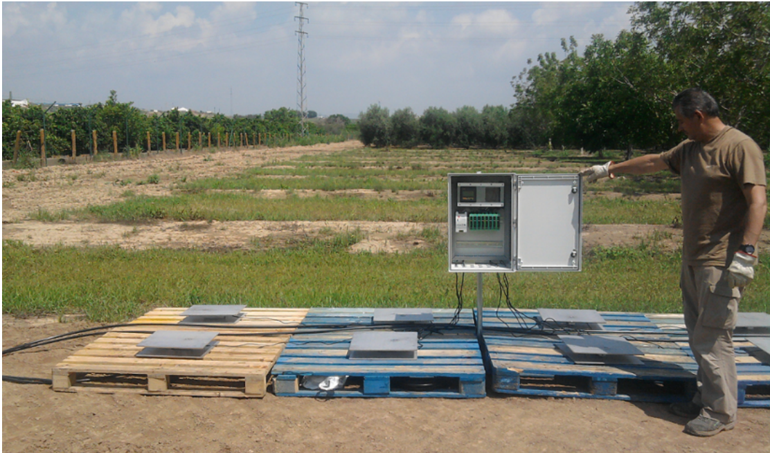
Figura 8.2: Preinstalación de células de carga en el lugar del ensayo.
