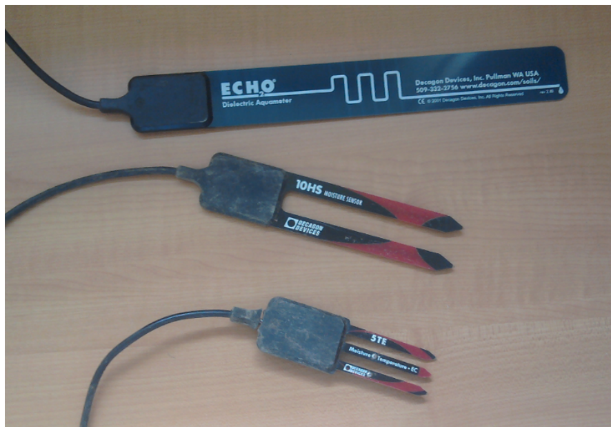
Figura 2.3: Sensores de humedad de Decagon Devices, Inc. De arriba a abajo: EC-20, 10HS y 5TE.
