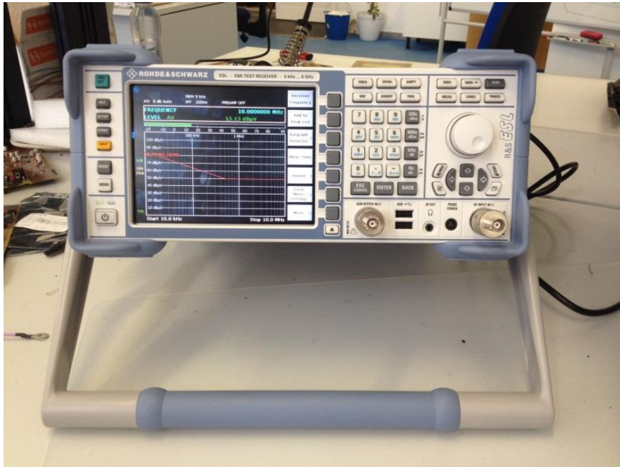
Figura 1.1 – Analizador de espectros con generador de tracking EMI TEST RECEIVER R&S ESL6
