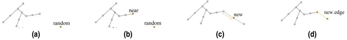
Figura 2.4 Generación de un nuevo estado en un RRT.
