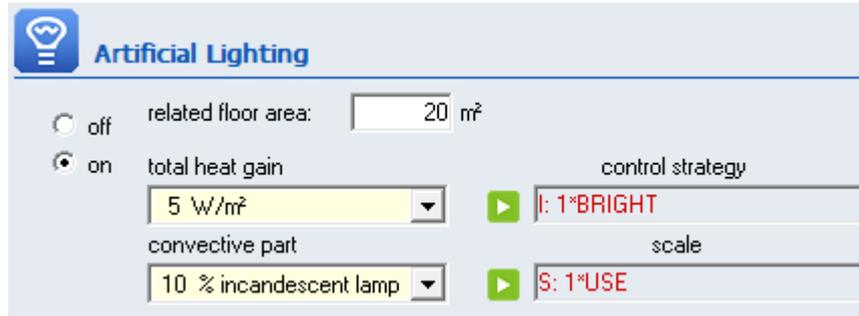
Figura 44: Carga térmica interna por iluminación
