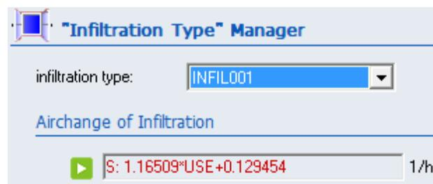
Figura 37: Intercambio de aire debido a las infiltraciones
