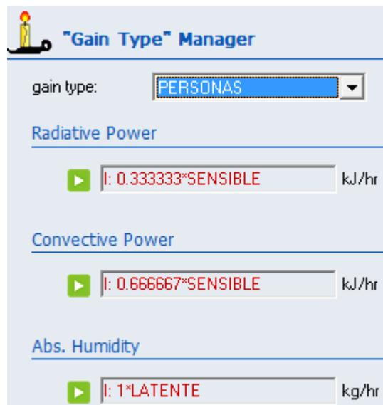
Figura 43: Carga térmica interior aportada por un pasajero
