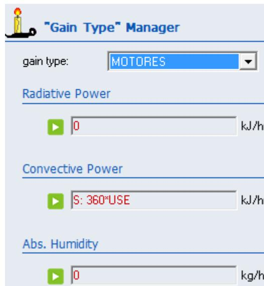
Figura 45: Ganancia térmica debida a los motores del sistema de impulsión de la climatización
