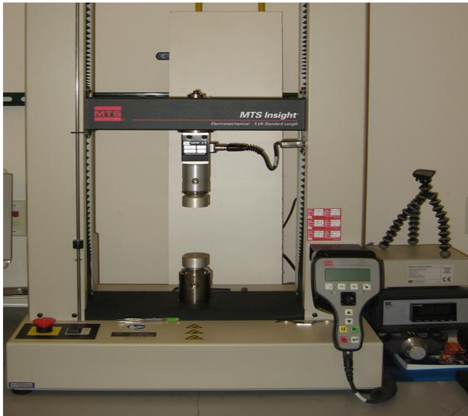
Figura 50. sistema de testado electromecánico (MTS Insight 10) utilizado.
